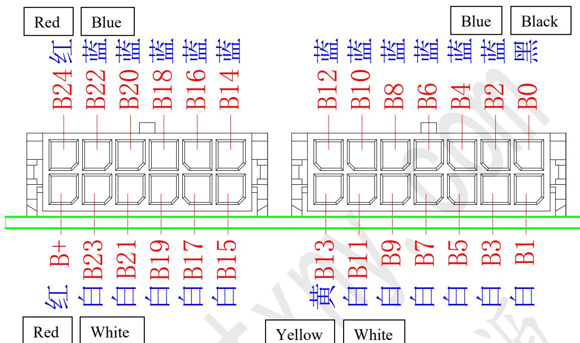
相关说明：采样排线的走线排布不要扯太紧，以免使用过程中拉扯松脱；主板插座和排线结合处要打胶固定。
