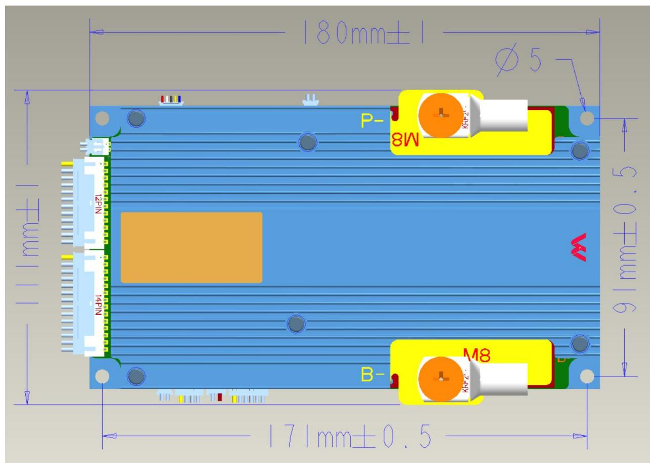
保护板尺寸: 180\*111\*26.5 【固定孔位中心尺寸171\*92,固定孔位螺丝M4】 (mm)
