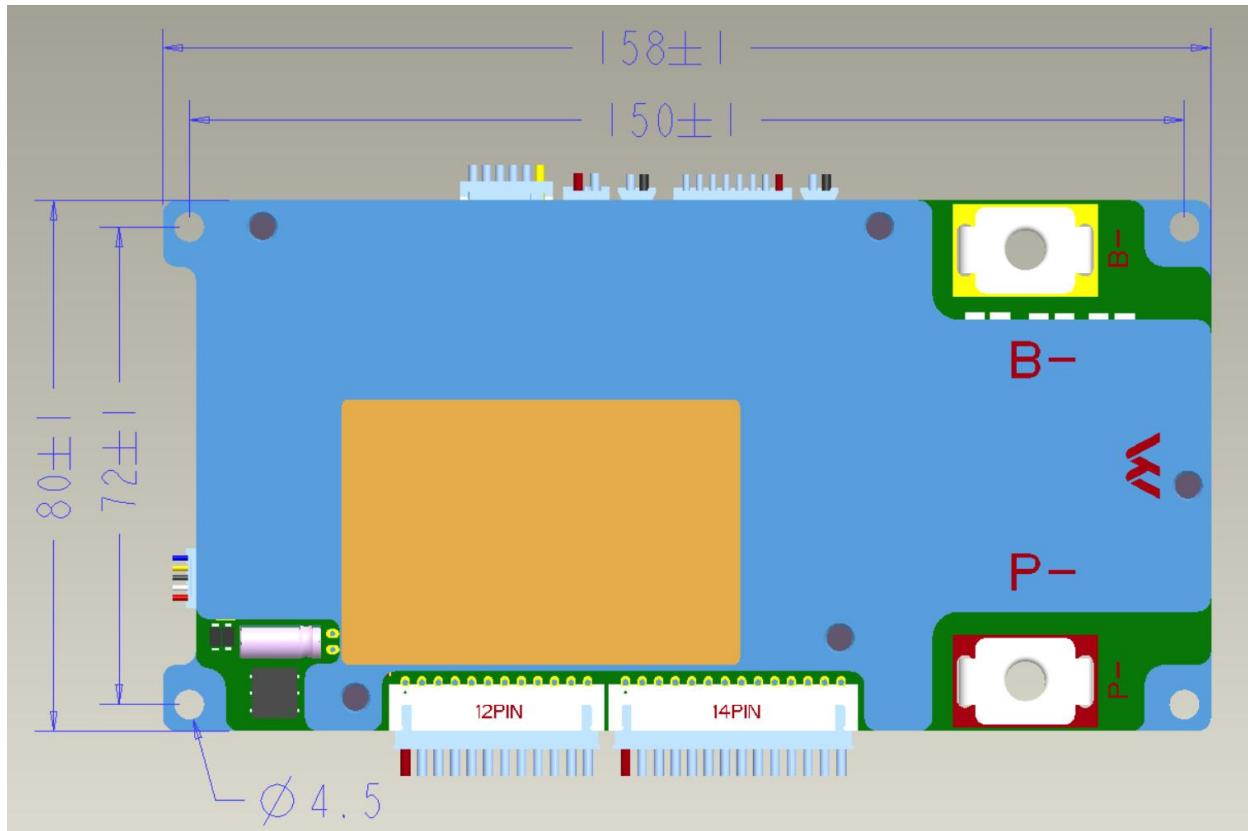
保护板尺寸: 158\*80\*17【固定孔位中心尺寸150\*72, 固定孔位螺丝M4】 (mm)
