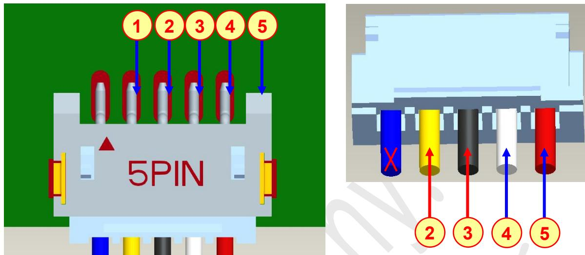
RS485&一线通 —— 采用ZH1.5间距-5PIN，外接线端可自定义
