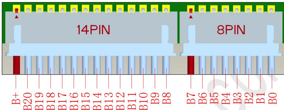
相关说明：采样排线的走线排布不要扯太紧，以免使用过程中拉扯松脱；主板插座和排线结合处要打胶固定。
