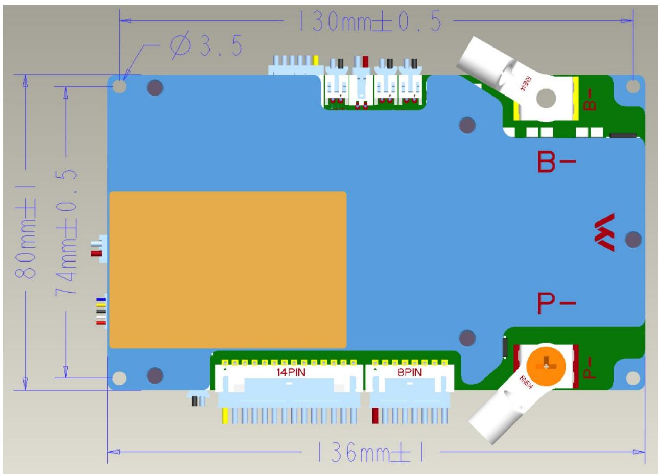
保护板尺寸：136\*80\*16.6【固定孔位中心尺寸130\*74，固定孔位螺丝M3】(mm)
