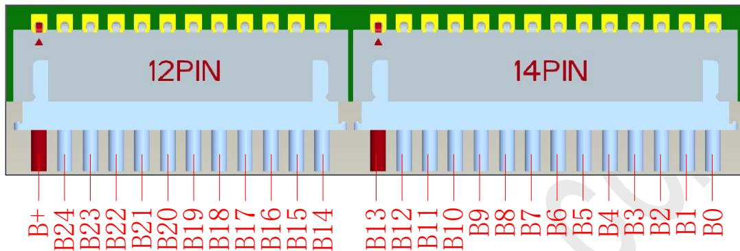
**相关说明：采样排线的走线排布不要扯太紧，以免使用过程中拉扯松脱；主板插座和排线结合处要打胶固定。**
