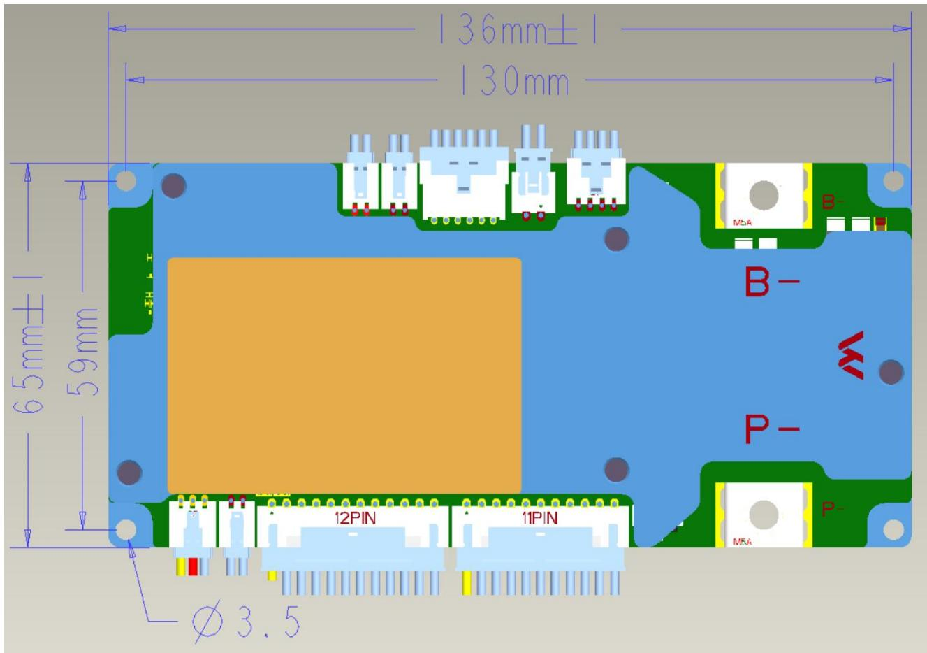
保护板尺寸：136\*65\*16.6【固定孔位中心尺寸130\*59，固定孔位螺丝M3】
