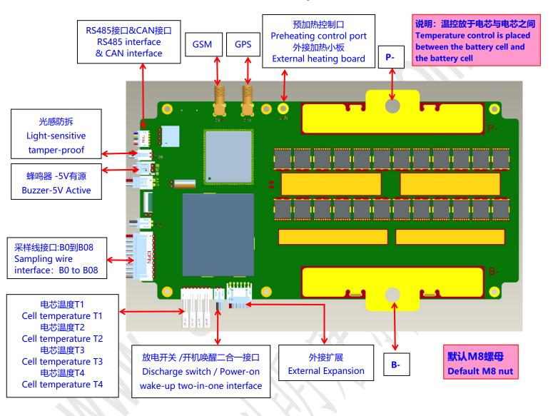
重要说明:电池采样线材、温度线、RS485通讯线等插接的线材,装好后要打胶固定,防止电池使用过程中震动脱落。
