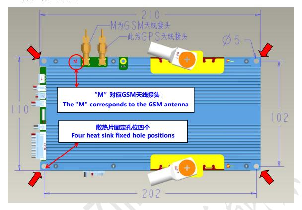
保护板尺寸: 210\*110\*21【固定孔位中心尺寸202\*102,固定螺丝M4】(mm)
