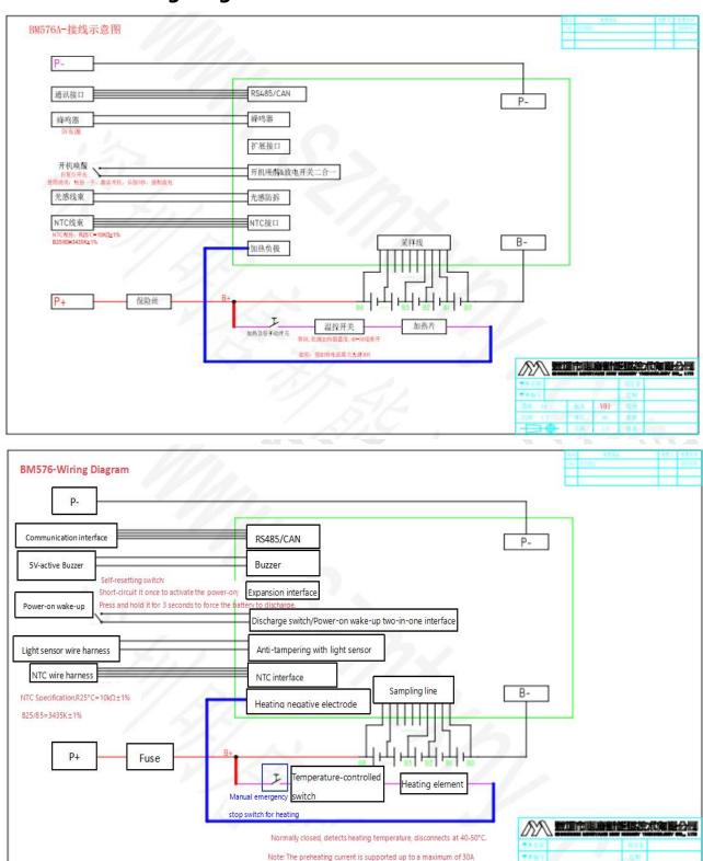
发热丝加热的接线示意图请参考上图,充电时加热【电芯低温才能开启发热丝加热功能】。
