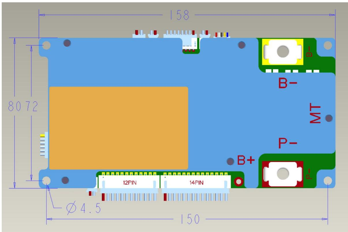
保护板尺寸：158\*80\*15.6【固定孔位中心尺寸150\*72,固定孔位螺丝M4】 (mm)
