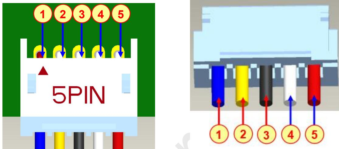
RS485&CAN —— 采用ZH1.5间距卧式5PIN，外接线端可自定义
