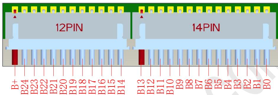
相关说明：采样排线的走线排布不要扯太紧，以免使用过程中拉扯松脱；主板插座和排线结合处要打胶固定。
