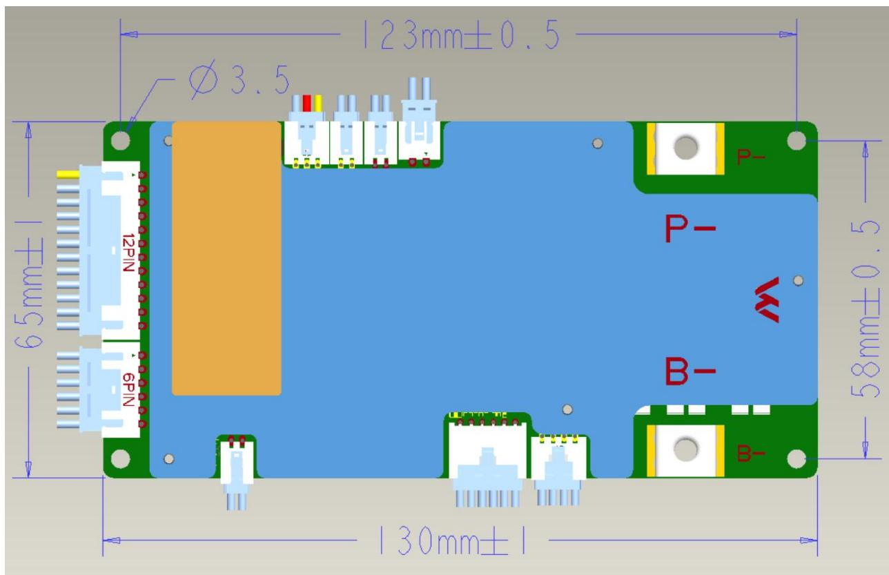
保护板尺寸: 130\*65\*12【固定孔位中心尺寸123\*58, 固定孔位螺丝M3】 (mm)
