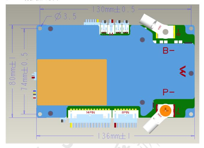
保护板尺寸: 136\*80\*16.6【固定孔位中心尺寸130\*74,固定孔位螺丝M3】 (mm)
