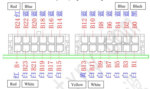
相关说明:采样排线的走线排布不要扯太紧,以免使用过程中拉扯松脱;主板插座和排线结合处要打胶固定。
