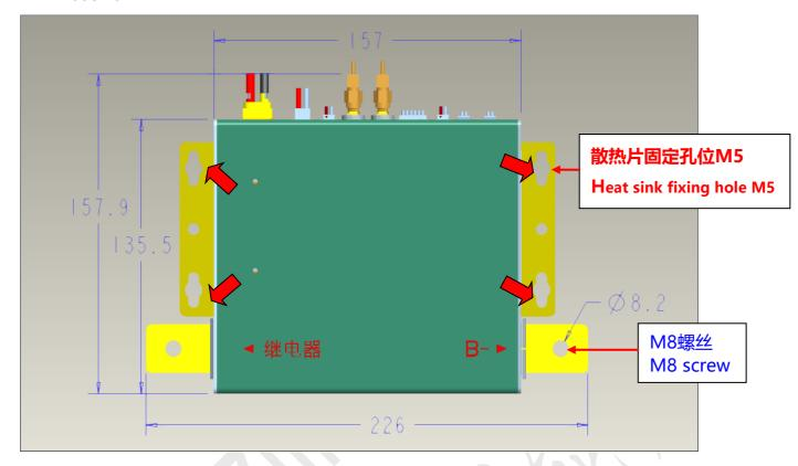
保护板尺寸: 226\*135.5\*36【固定孔位中心尺寸178\*60,固定孔位螺丝M5】(mm) Size of protection plate: 226\*135.5\*36 [fixed hole center size 178\*60, fixing hole position screws M5] (mm)
