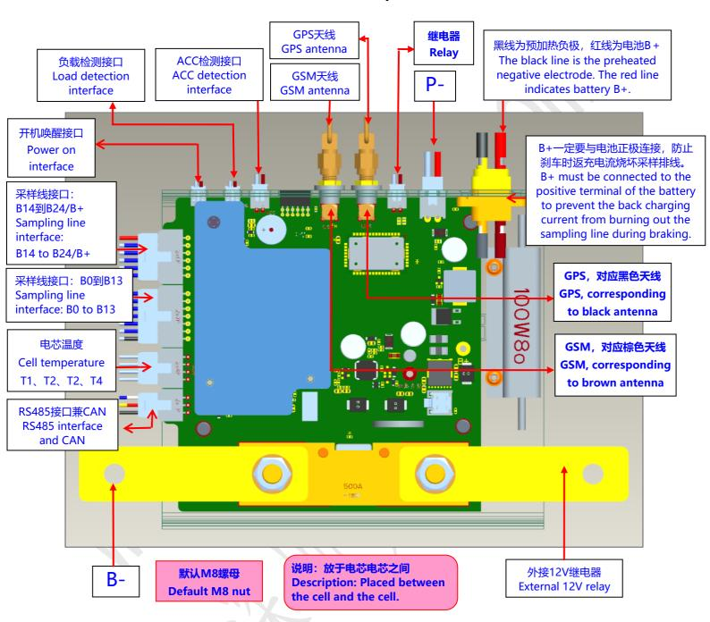
重要说明:电池采样线材、温度线、RS485通讯线等插接的线材,装好后要打胶固定,防止电池使用过程中震动脱落。
