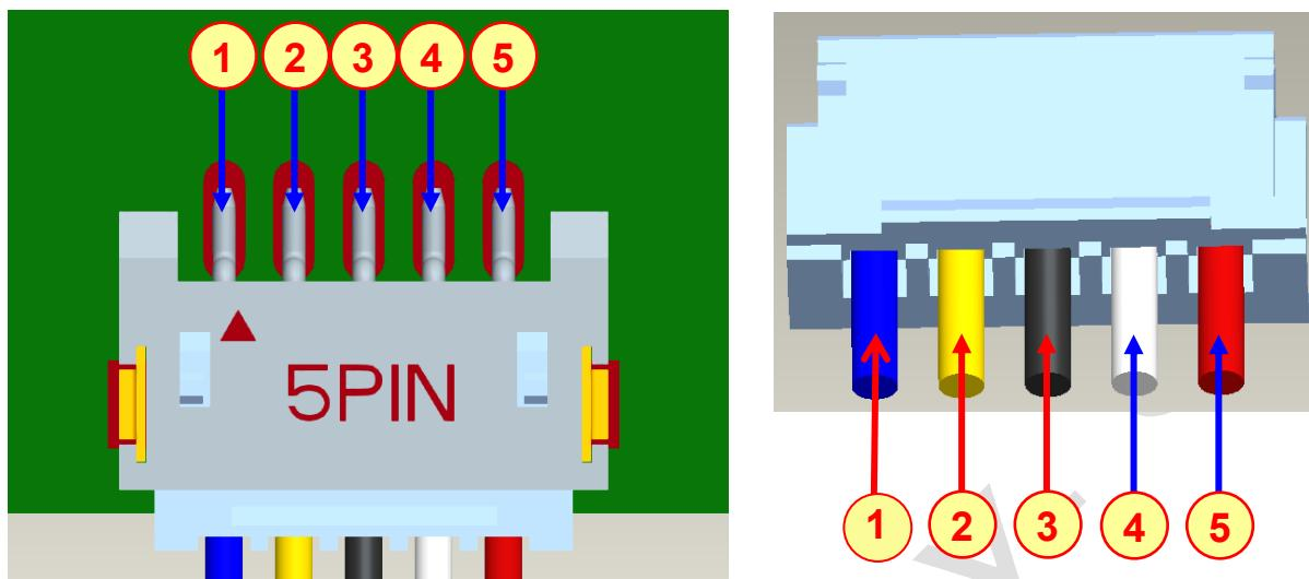
RS485&CAN —— 采用ZH1.5间距-5PIN，外接线端可自定义
