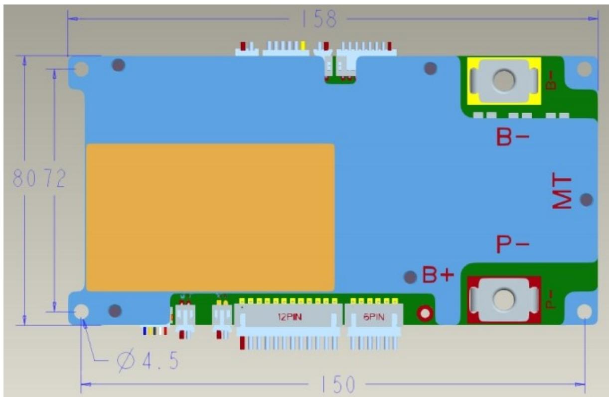
保护板尺寸: 158\*80\*15.6【固定孔位中心尺寸150\*72】 (mm)
