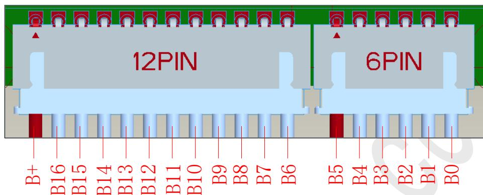
相关说明：采样排线的走线排布不要扯太紧，以免使用过程中拉扯松脱；主板插座和排线结合处要打胶固定。
